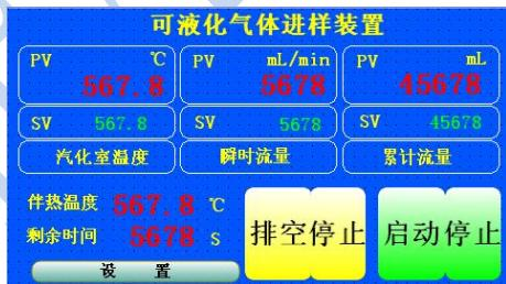
汽化室温度：PV 表示当前温度，SV 表示设置温度，用户可以修改：室温~120°C。
